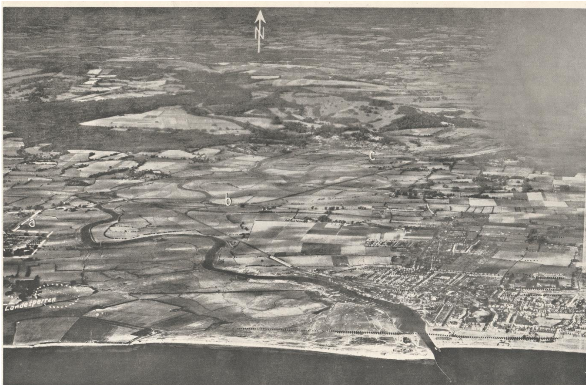
Abb. 1 Littlehampton (10 000 Einw.) an der durch Leitdämme eingefassten Mündung des River Arun bei Hochwasser, von den beiden Bühnen in Verlängerung der Leitdämme ragt nur die westliche aus dem Wasser heraus. Flugplatz Ford (a), Eisenbahnkreuzung (b), Arundel (c) mit markantem Schloß über dem Flußtal, dahinter der bewaldete Anstieg der South Downs
